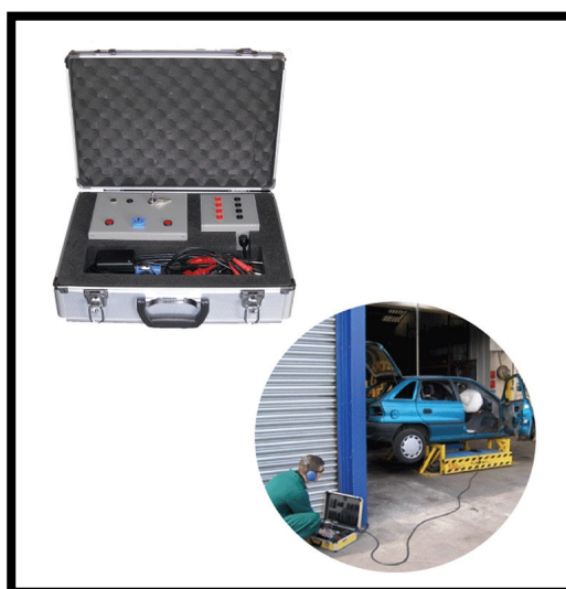
IMATGE 3. EQUIPAMENT I PROCÉS DE DETONACIÓ DELS AIRBAGS.
