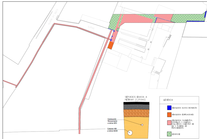
Figura 9. Plano de demoliciones
