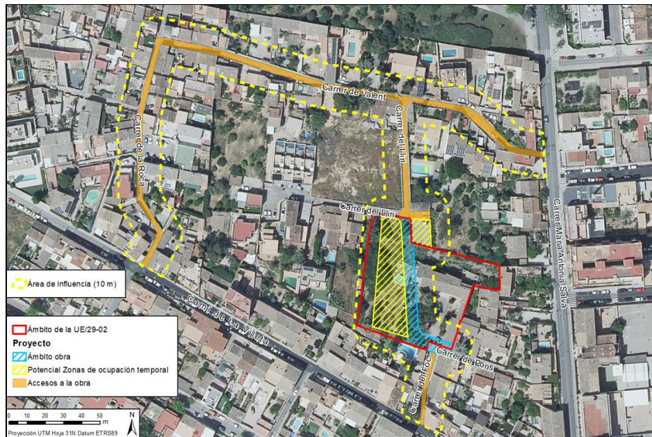
Figura 20. Zonas sensibles al ruido de la obra
