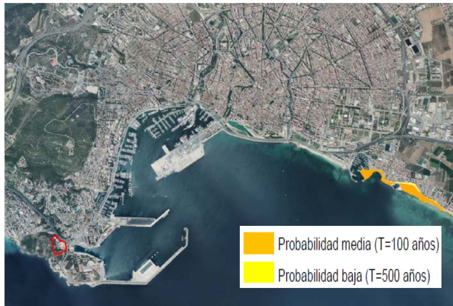
FIGURA 6.1 ZONA INUNDABLE DE ORIGEN MARINO EN LAS PROXIMIDADES DEL PROYECTO
