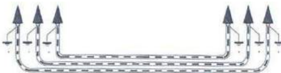
Ilustración 7. Puesta a tierra cubiertas metálicas
