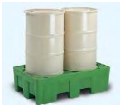
Fotografia 11. Cubeta de contenció de polietilè doble que es col·locaran davall les caixes i/o els bidons que contenen residus especials/perillosos per fer front a possibles vessaments.
