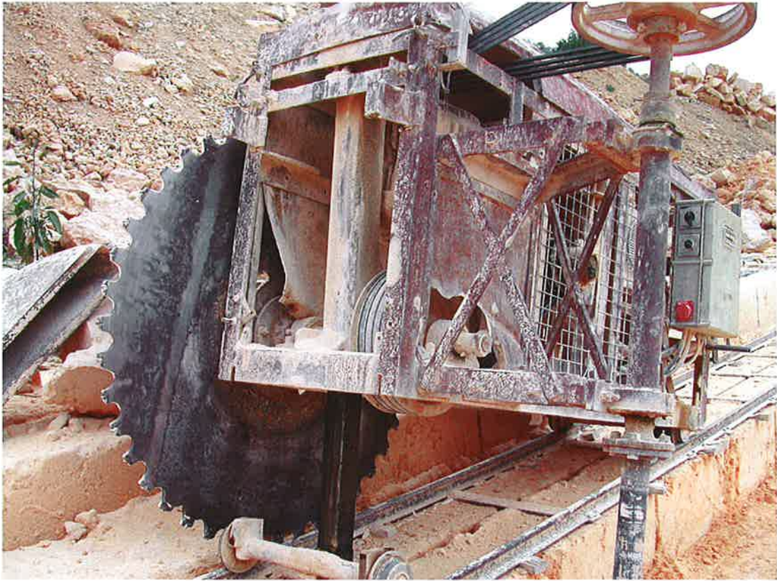
FOTOGRAFIA 2: Máquina parada y en posición para profundizar el corte vertical
