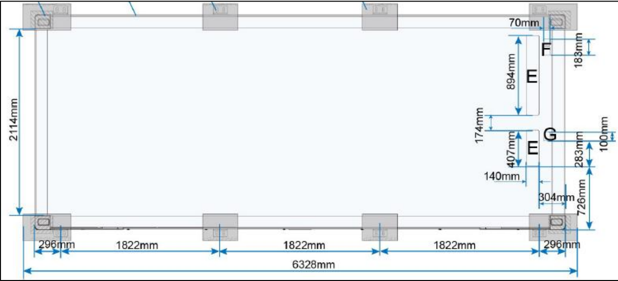
Imagen 33. Cimentaciones propuestas por el fabricante
