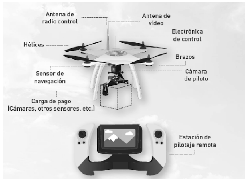
Figura 5. Esquema sistema RPA. Fuente propia.
